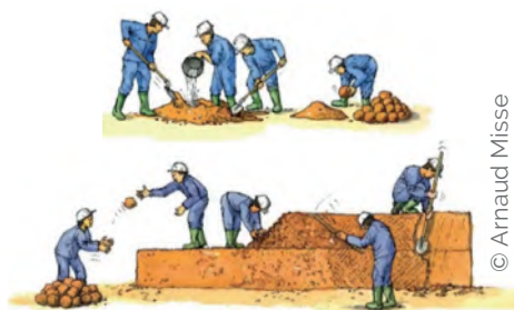
Mise en œuvre traditionnelle de la bauge
