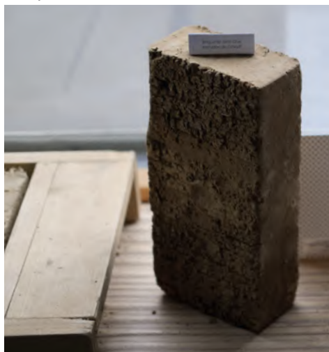
Prototypé de brique de terre crue extrudée de la briqueterie Dewulf
