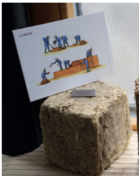
Échantillon de petite dimension de bauge, réalisé par de Terramano, chargé en paille
