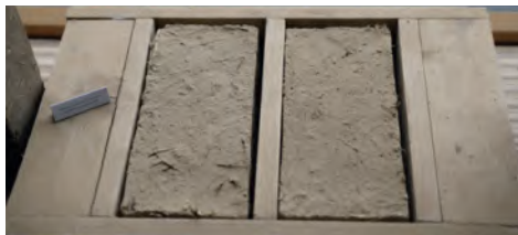
Moule d'adobe et adobes réalisées en chantier participatif
