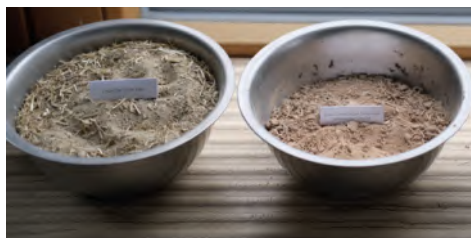
Mélanges, chargés de fibre, destinés à la pose d'enduit
