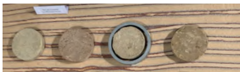
Test dit «de la pastille» sur différentes terres, indiquant le retrait au séchage, propre à la terre employée
