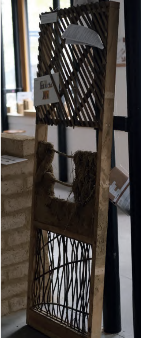
Prototype de torchis - Fabriqué par Landfabrik, le Charpentier Volant et Sophie Popot. Support à claire-voie en Bakuda de réemploi de la Grande Coco et Cornouiller Normand. Lattes et torches préparées avec un mélange de terre francilienne (Villennes-sur-Seine) et de foin.
