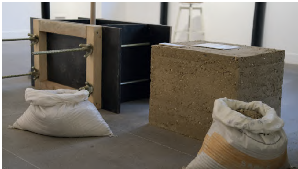
Prototype de pisé - Fabriqué par Les Grands Moyens Construction (Kevin) et le Collectif francilien de la terre crue (Anna-Laura).
