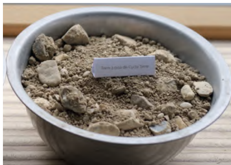
Terre à piser prête à l'emploi de Cycle Terre formulée avec les terres d'excavation du Grand Paris.
