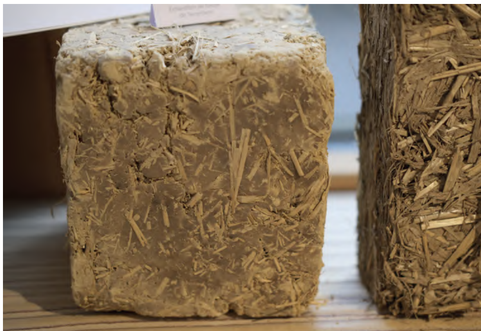
Échantillon de petite dimension de bauge, réalisé par de Terramano, chargé en paille
